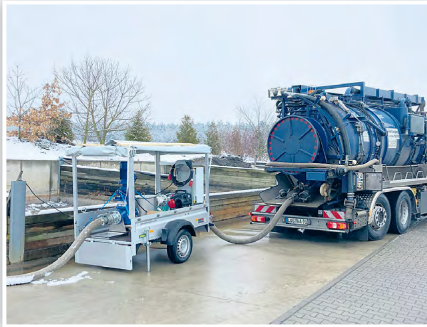
So funktioniert es: Der Zerkleinerer besteht aus zwei Wellen, die mit scharfen Schneidrädern ausgestattet sind. Diese Wellen zerreißen und zerschneiden die Masse zu einem Brei, der dann mühelos weiterbefördert werden kann.
